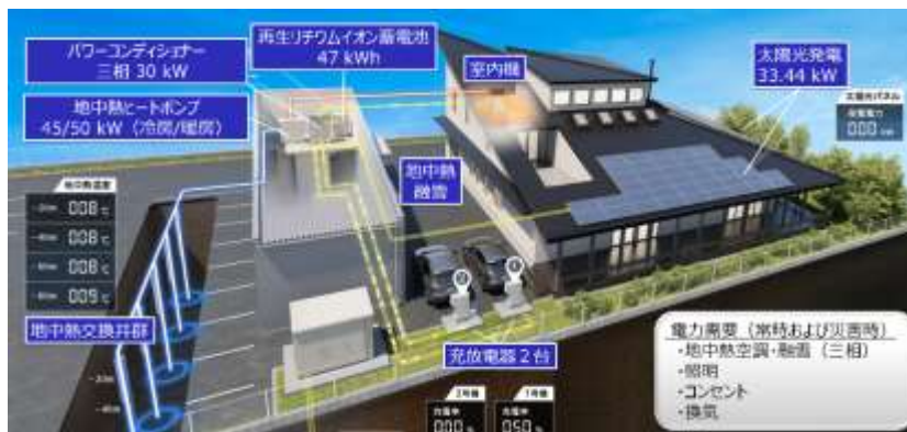
地中熱利用と EV・蓄電池で再エネを無駄なく活用し 災害時に拠点となる先導的な ZEB オフィスビル
